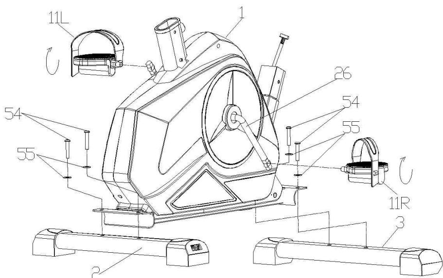
1. а) Прикрепите передний стабилизатор (3) и задний стабилизатор (2) к основной раме (1) с помощью винта M8\*P1.25\*50L (6мм) (54) и шайбы (55). Обратите внимание на то, что передний стабилизатор (3) имеет транспортировочное колесико, что облегчает перемещение тренажера. Задний стабилизатор такого колеса не имеет колесика.
