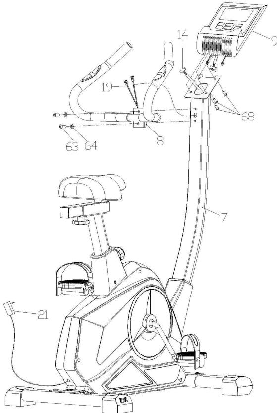
1. а) Подключите датчик, как показано на рисунке выше, следя за тем, чтобы все контакты были исправны. Несоблюдение этого требования может привести к неисправности консоли.
