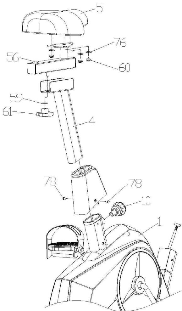
2. а) Прикрепите сиденье (5) к блоку подвижного элемента сиденья (56) с помощью шайбы (76) и нейлоновой гайки (60), затем надежно зафиксируйте сиденье (5).
